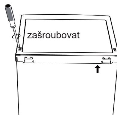
10. Než definitivně dotáhnete šrouby, se zavřenými dveřmi zkontrolujte, zda dveře horizontálně i vertikálně líčují a zda těsnění po všech stranách správně dosedá.
