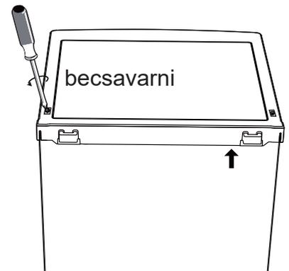
10. Mielőtt véglegesen rögzíti az ajtó csavarjait ellenőrizze az ajtó vízszintes és függőleges pozícióját, illetve a tömítés megfelelő működését!
