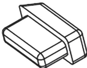
Neodstraňujte tyto gumové tlumící bloky ze dveří. Pokud by na některých dveřích tento blok chyběl – nahraďte ho novým (je součástí drobného příslušenství v sáčku spolu s návodem k použití).
