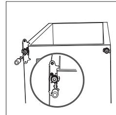
8. Obrócić zawias środkowy o  $180^\circ$ , następnie przemieścić go na lewą stronę. Zasunąć kolek zawiasu do dolnego otworu drzwi i dokręcić śrubę
