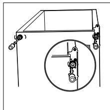
6. Odkręcić u usunąć kołek dolnego zawiasu, obrócić konsole i zamontować z powrotem.
