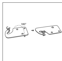
10. Nasadzić z powrotem górne drzwi. Przed ostatecznym dokręceniem górnego zawiasu skontrolować, czy drzwi są pionowo i poziomo spasowane i czy uszczelka na wszystkich stronach prawidłowo przylega. Następnie przyłożyć zawias i przykręcić go do górnej części urządzenia.
