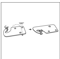
10. Nasadťte horné dvere späť. Než definitívne zaskrutkujete horný záves, skontrolujte, či dvere horizontálne aj vertikálne doliehajú a či tesnenie po všetkých stranach správne dosadá. Potom priložte záves a zaskrutkujte ho do hornej časti spotrebiča.
