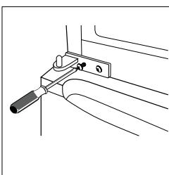
9. Csavarozza le a felfüggesztés csapját és fordítsa el a felfüggesztést. Ezután a felfüggesztés csapját helyezze ismét vissza.
