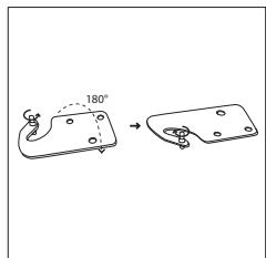
10. Helyezze vissza a felső ajtót. A felső tartó végleges becsavarozása előtt győződjön meg arról, hogy az ajtó vízszintesen és függőlegesen vonalban van-e és a tömítés minden oldalon meg- flelően helyezkedik-e el. Ezután helyezze el a felfüggesztést és csavarozza azt a készülék felső részéhez.
