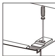
7. Zložte horné dverka, vyberte skrutky zo stredného závěsu krížovým skrutkovačom, potom zložte spodné dvere.
