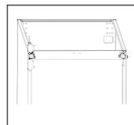
12. Zo spodnej časti horných a dolných dverok odstráňte namontované "dverné poistky", vyberte nové "dverné poistky" z vrečka s príslušenstvom a namontujte ich na ľavú stranu oboch dverí.
