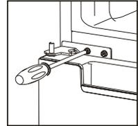
15. Nasadte horní dvířka, ujistěte se, že jsou dvířka zarovnána se skříň chladničky a správně těsní. Poté dvířka upevněte ke skříni pečlivým přišroubováním horního závěsu.
