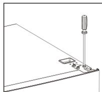
3. Vyměňte čep pomocí šroubováku a otočte držák závěsu. Poté opět připevněte čep k držáku závěsu.
