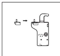
5. Odstráňte kryt v hornej časti horných dvierok a presuňte spojovací konektor z pravej strany na ľavú stranu a potom kryt nasadíte späť.
