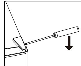
2. Odskrutkujte horný záves pomocou krížového skrutkovača.
