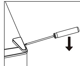
2. Odšroubujte horní závěs pomocí křížového šroubováku.
