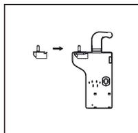
5. Odstráňte kryt v hornej časti horných dvierok a presuňte spojovací konektor z pravej strany na ľavú stranu a potom kryt nasadte späť.
