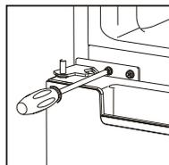
15. Nasadte horní dvířka, ujistěte se, že jsou dvířka zarovnána se skříň chladničky a správně těsní. Poté dvířka upevněte ke skříni pečlivým přišroubováním horního závěsu.
