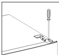
3. Vyjměte čep pomocí šroubováku a otočte držák závěsu. Poté opět připevněte čep k držáku závěsu.
