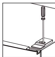
7. Zložte horné dvierka, vyberte skrutky zo stredného závesu krížovým skrutkovačom, potom zložte spodné dvere.
