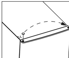
5. Položte zadní stranu skříně na měkkou podložku. A odšroubujte spodní závěs a vyrovnávací nožky.
