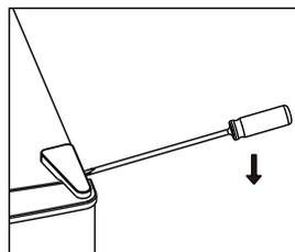
2. Odšroubujte horní závěs pomocí křížového šroubováku.
