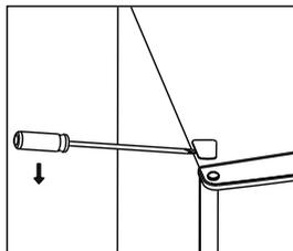
4. Přesuňte kryt otvoru pro pant zleva doprava. Potom zvedněte horní dvířka a umístěte je na měkký povrch, aby se zabránilo poškrábání.
