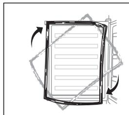
9. Postavte chladničku a nasadte dveře na spodní závěs. Ujistěte se, že čep spodního závěsu je zasunut do spodního otvoru dveří. Namontujte dvířka s horním závěsem
