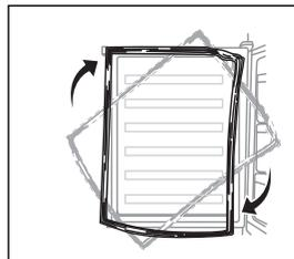
9. Postavte chladničku a nasadte dvere na spodný záves. Uistite sa, že čap spodného závesu je zasunutý do spodného otvoru dverí. Namontujte dvierka s horným závesom.
