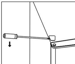
4. Presuňte kryt otvoru pre pánt zľava doprava. Potom zdvihnite horné dvierka a umiestnite ich na mäkký povrch, aby sa zabránilo poškrabaniu.
