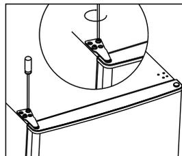
10. Zaklapněte kryt závěsů a kryt otvorů na horní části chladničky.
