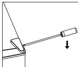
2. Odskrutkujte horný záves pomocou krížového skrutkovača.
