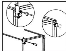
10. Postavte chladničku a nasadte dveře na spodní závěs. Ujistěte se, že čep spodního závěsu je zasunut do spodního otvoru dveří. Poté přesuňte kryt otvoru dolních dveří z levé strany na pravou stranu.
