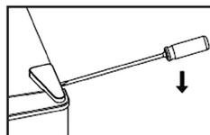
2. Odskrutkujte horný záves pomocou križového skrutkovača.
