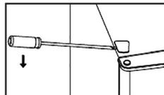
4. Presuňte kryt otvoru pre pánt zľava doprava. Potom zdvihnite horné dvierka a umiestnite ich na mäkký povrch, aby sa zabránilo poškrabaniu.
