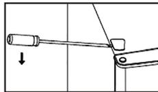
4. Přesuňte kryt otvoru pro pant zleva doprava. Potom zvedněte horní dvířka a umístěte je na měkký povrch, aby se zabránilo poškrábání.
