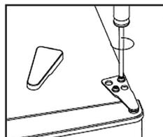
3. Odstráňte kryt otvoru plochým skrutkovačom.
