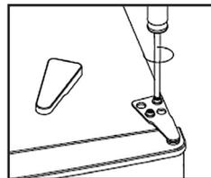
2. Odšroubujte horní závěs pomocí křížového šroubováku.
