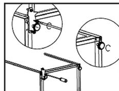
10. Postavte chladničku a nasadte dvere na spodný záves. Uistite sa, že čap spodného závesu je zasunutý do spodného otvoru dverí. Potom presuňte kryt otvoru dolných dverí z ľavej strany na pravú stranu.
