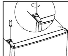
13. Zaklapněte kryt závěsů a kryt otvorů na horní části chladničky.
