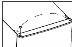
5. Odšroubujte prostřední závěs a poté zvedněte spodní dvířka a položte je na měkkou podložku, aby nedošlo k poškrábání.
