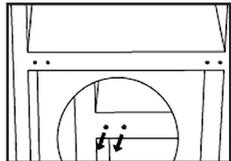
7. Položte zadní stranu skříně na měkkou podložku. A odšroubujte spodní závěs a vyrovnávací nožky.
